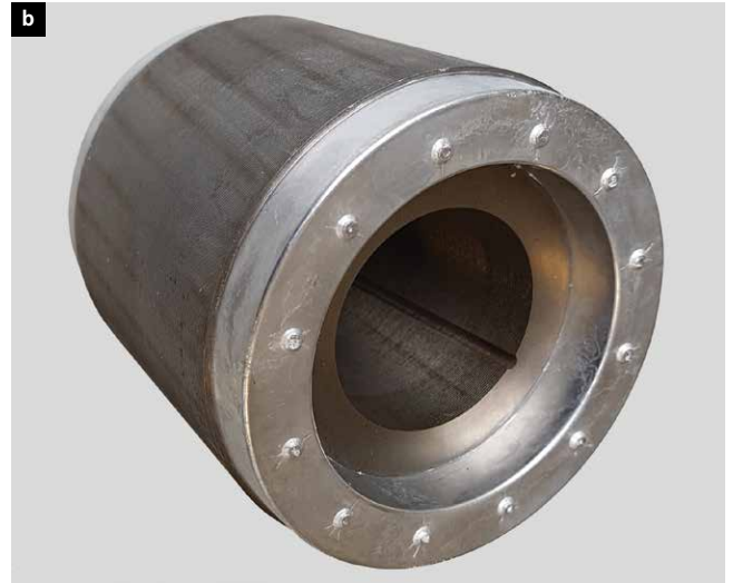
Bild 4: a) Dreidimensionale Darstellung der Gussdefekte und Fehlerverteilung aus der High-Energy-CT. b) Foto des optisch vermeintlich fehlerfreien Rotors.
